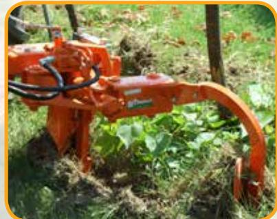
Charrue hydraulique pour chauffer monté à un châssis fixe complète de système hydraulique indépendante pour renverser la terre. On y peut atteler un ou deux socs antérieurs pour augmenter la largeur de travail et on peut y monter socs pour déchausser les rangées.
