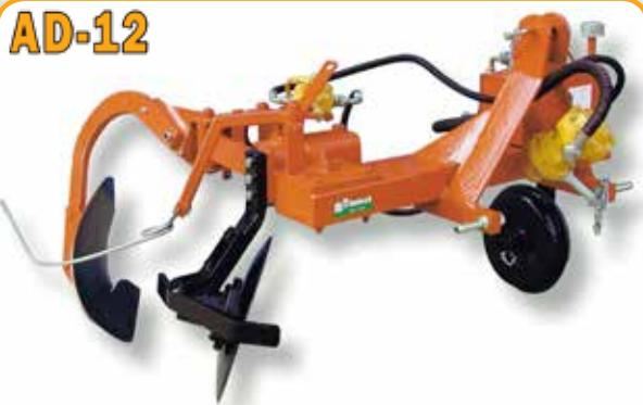
Arato scalzatore idraulico con disco aprisolco su telaio portato fisso completo di impianto idraulico indipendente, per la scalzatura di vigneti. Questo modello è adatto per filari stretti (cm 120 - 150) e per trattori con ingombro massimo di cm 110.
