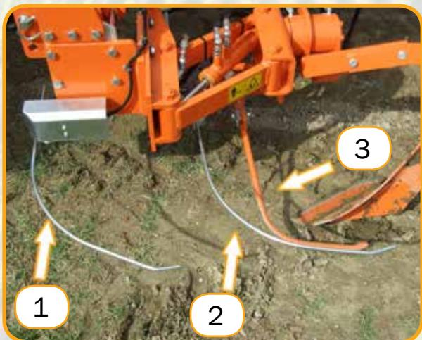
1 tastatore di posizionamento
