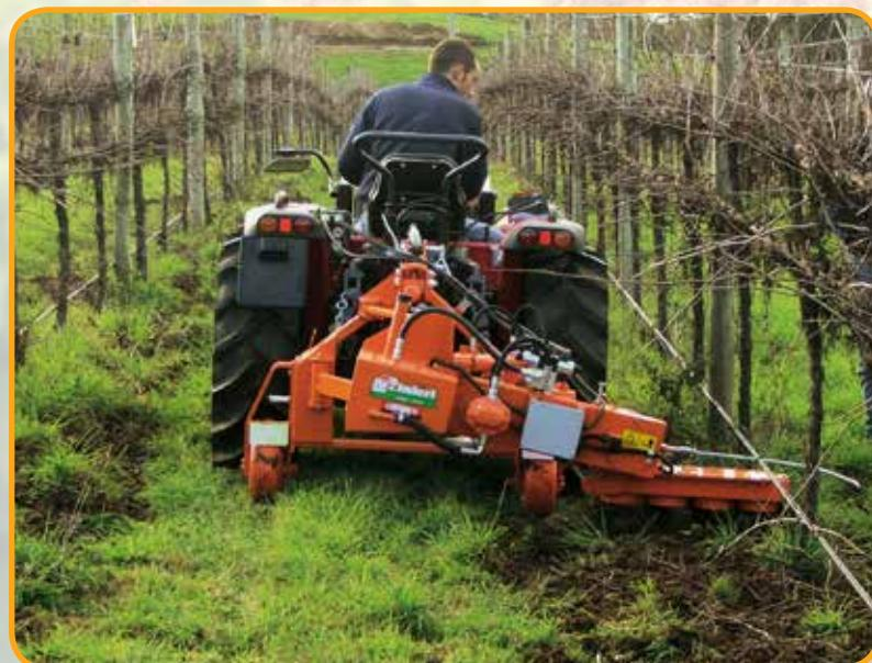
Coltivatrice interceppi ELX abbina ridotte misure di ingombro alla massima robustezza per una grande affidabilità anche in condizioni estreme. Dotata di 3 bracci per lo spostamento, di un dispositivo antiurto con molla a gas per attutire i colpi più violenti e cardano con limitatore a nottolini. E' adatta ai clienti più esigenti che devono lavorare in condizioni molto difficili, terreni molto compatti e sassosi. A richiesta è disponibile un sistema di guida automatico RSA.
