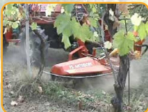
Serie di fresatrici interceppi anteriori prodotte per essere utilizzate con trattori a guida retroversa o con sollevatore anteriore. Pur mantenendo la stessa efficacia e le stesse caratteristiche delle frese posteriori FS, hanno il vantaggio di una migliore visibilità di lavoro. Vengono costruite in diverse misure di spostamento per filari da m. 2,50 fino a 6 mt.
