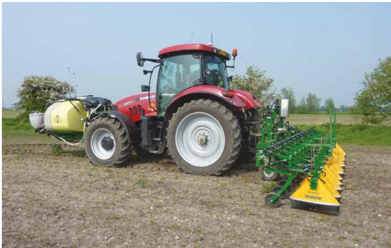
Varidome S3 utilisé sur betteraves avec guidage GPS RTK.
