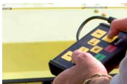
Câble de commande à distance avec flexible en spirale
