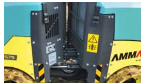
Articulation centrale oscillante du châssis sans entretien pour un contact parfait avec le sol
