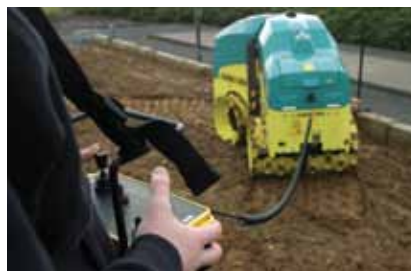
Une connexion supplémentaire par câble comme standard simple pour le transport
