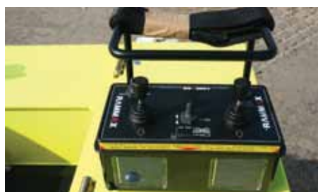
Émetteur infrarouge manuel avec capteurs solaires
