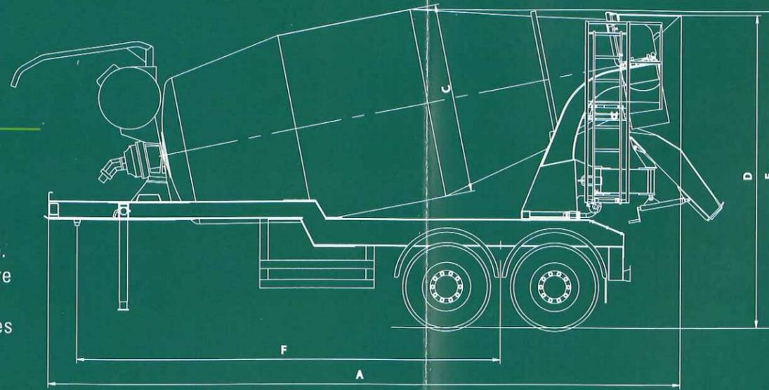
Selon le tracteur, les semi-remorques sont conçues d'une manière modulaire dans des versions 2 ou 3 essieux avec une charge par essieu de 9 à 10 tonnes. Elles sont bien évidemment équipées des freins à disques et du système ABS de dernière génération, ainsi que des systèmes d'amortisseurs pneumatiques EBS et, à la demande, du système RSS (Road Stability System). Les bétonnières portées **Stetter** sur semi-remorque, sont disponibles dans des volumes nominaux de 10 ou 12 m<sup>3</sup>.
