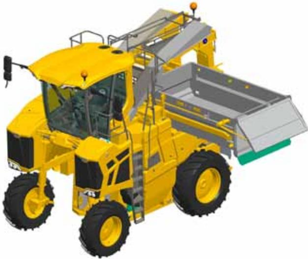
La benne centrale en inox **GREGOIRE** offre la capacité de stockage la plus importante du marché sur ce segment. Ce système vous offre un contrôle total de la phase de vidage et même la possibilité de vider partiellement la benne si nécessaire grâce à la porte à commande hydraulique. Il vous est aussi possible de vider la benne sans quitter le rang de vigne, une rallonge de bennes est disponible pour les rangs les plus larges
