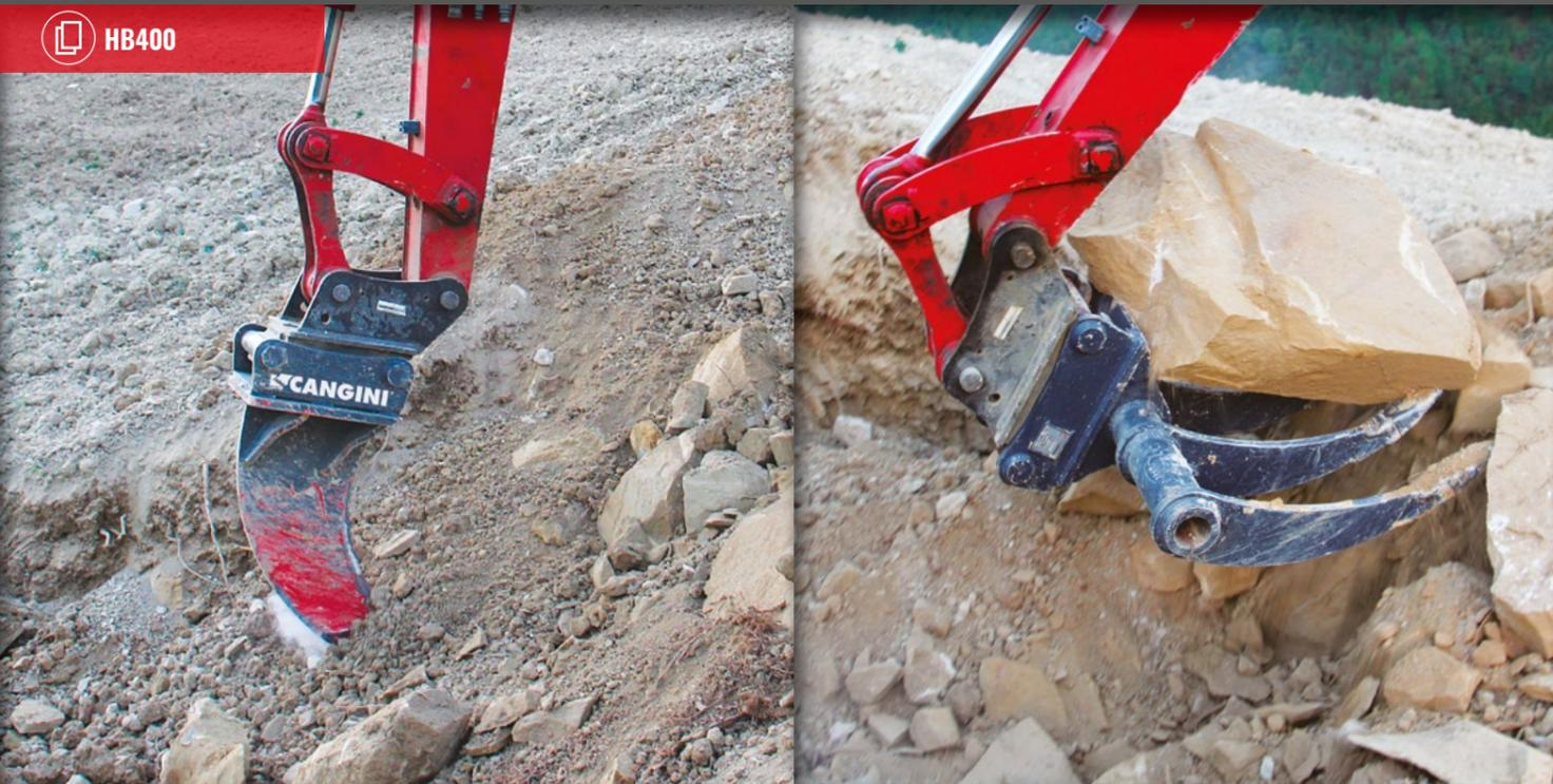
Le dent Single-Force Ripper est entièrement fabriqué en HB400. Adapté aux opérations de défrichage, scarifiage, arrachage et extraction de pierres.
