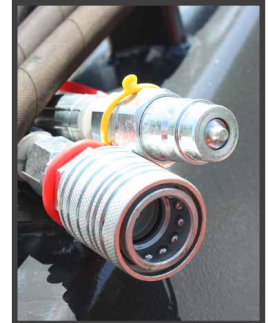
Prises d'huile hydrauliques (de série)
