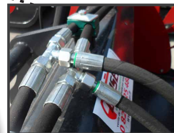
Raccord hydraulique en T (branchement par 2 prises d'huile hydraulique)
