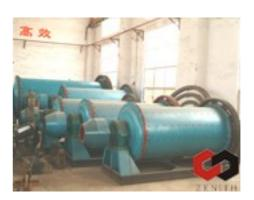
Le moulin à boulets est un instrument efficace pour le broyage de poudre fine. Le moulin à boulets est employé de broyer beaucoup sortes des minerais et les autres matériaux ou afin de choisir le minerai. Le moulin à boulets est amplement appliqué dans le matériel de construction, l'industrie chimique,etc... Il a deux méthodes de broyage : méthode de sécher et celle de mouiller. Il est divisé par le type tabulaire et celui coulant en fonction du différent minerai explusé.
