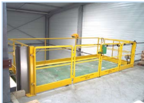
Portillon avec serrure à commande hydraulique
