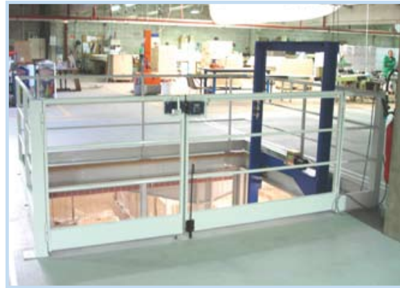
Porte rapide en partie basse avec commande par boîte à boutons et portillon en partie haute
