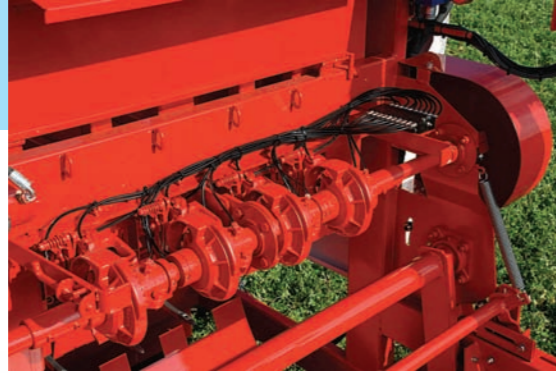
ENGRASE CENTRALIZADO DE ATADORES CENTRALIZED GREASING OF BINDERS GRAISSAGE CENTRALISÉ DE LIEUSES ZENTRAL SCHMIERANLAGE DES BINDEGERÄTS
