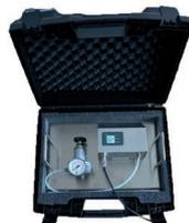
Mesure de la qualité de l'air comprimé
