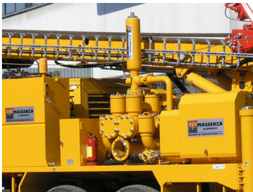
Pompa fango Mud pump Pompe à boue Spülpumpe Bomba de lodo Грязевой насос
