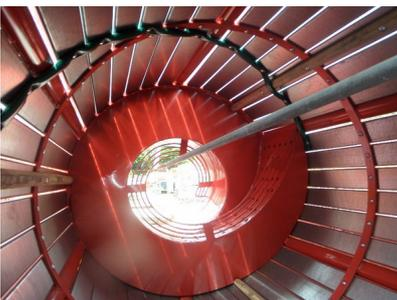
**Tambour inox - à lamelles interchangeable - avec système antistatique efficace.**
