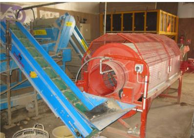
**Machine qui s'adapte facilement dans une chaîne complète de conditionnement. Elle peut s'utiliser en continu (pour ceux qui ont un forage) ou en circuit fermé afin de préserver l'eau. Existe avec tambour de 2 ml ou 3 ml selon besoins.**
