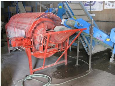
**Laveuse facilement utilisable et au rendement avec entonnoir d'entrée (possibilité de coupler à un tapis ameneur Krukowiak) et grille de séchage en sortie avec répartiteur.**
