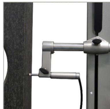
Mesure de la perpendicularité avec palpeur électronique (V6) (TA-IH-136, TA-MS-101)
