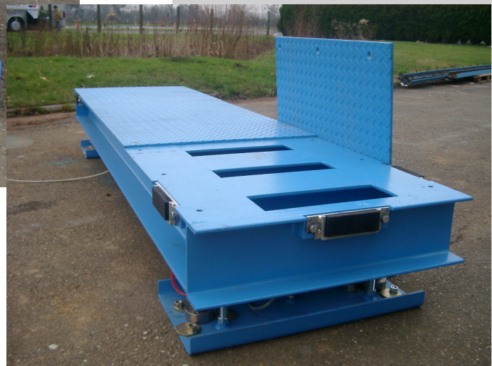
Accès par démontage du tablier métallique
