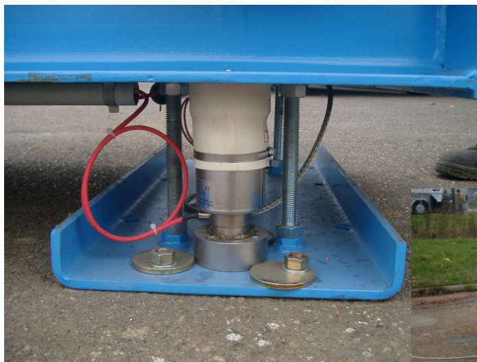
Détail du cuvelage et des capteurs
