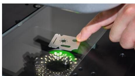
**6** Z-Achse bewegen, bis die Abbildung richtig scharf erscheint, und die Beleuchtungen zur optimalen Erfassung der Kanten entsprechend einstellen.
