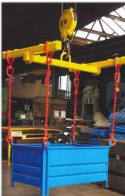
Le palonnier, Modèle 11/15 est un outil facilement manipulable, répondant aux normes en vigueur de manutention-levage en ateliers. Il permet en particulier la manutention des caisses palettes type VP68 et VP812. La préhension s'effectue à la verticale de chaque point d'arrimage à l'aide de chaînes ou élingues, dotées en extrémités basses de crochets avec système de sécurité. En partie haute, ces chaînes ou crochets sont reliés par manilles au palonnier conçu en poutres largement dimensionnées.
