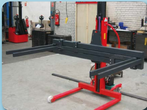
Fourches ajustables extensibles et extra larges pour prendre des charges longues. (exp. profils aluminium) Appareil stabilisé par des longerons encadrants.
