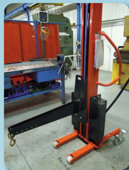
Fourches ajustables extensibles et extra larges pour prendre des charges longues. (exp. profils aluminium) Appareil stabilisé par des longerons encadrants.
