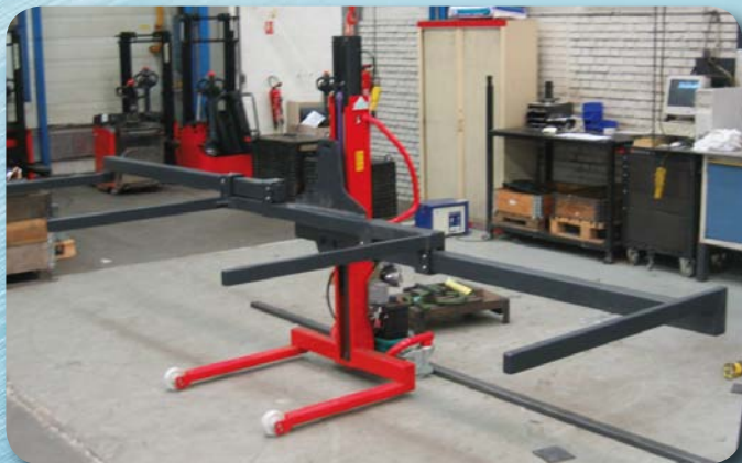
Fourches ajustables extensibles et extra larges pour prendre des charges longues. (exp. profils aluminium) Appareil stabilisé par des longerons encadrants.
