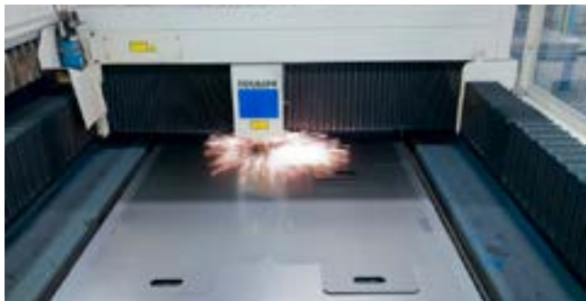
Découpe laser d'une tôle d'acier
