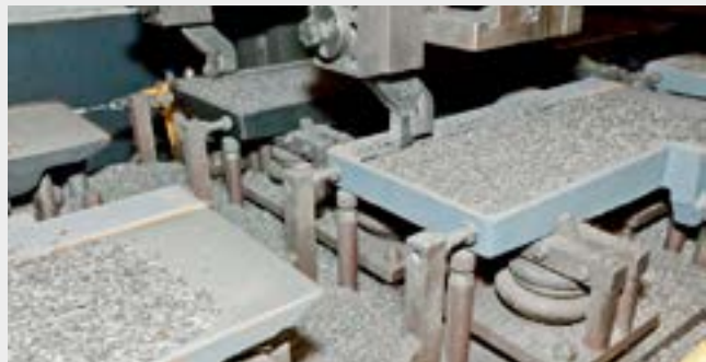
Rectification d'une table en fonte
