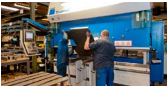
Pliage assisté par ordinateur d'une tôle acier
