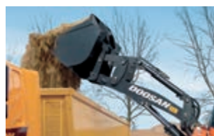
Groupe de travail à cinématique parallèle (spéciale accessoires) La cinématique parallèle assure un angle d'inclinaison constant sur toute l'étendue de l'arc de levage ainsi qu'une force de rappel supérieure à hauteur max.
