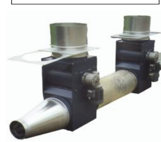
STYROMETER POUR BLOCS OU PPE (9)
