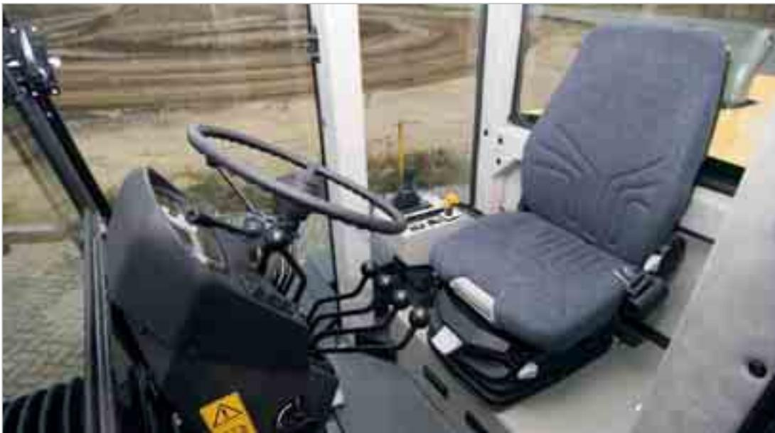
Outre le grand confort et l'excellente visibilité, l'ultra spacieuse cabine ROPS/FOPS assure aussi à l'opérateur toute la sécurité nécessaire et un siège qui le maintient en bonne position, même en cas de travaux de talutage.
