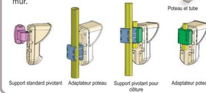
Support standard pivotant    Adaptateur poteau    Support pivotant pour clôture    Adaptateur poteau
