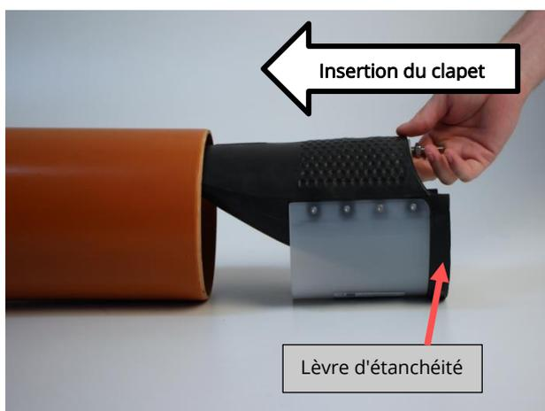
Insérez la vanne dans le tuyau jusqu'à ce que la lèvre d'étanchéité soit complètement en contact avec le tuyau.
