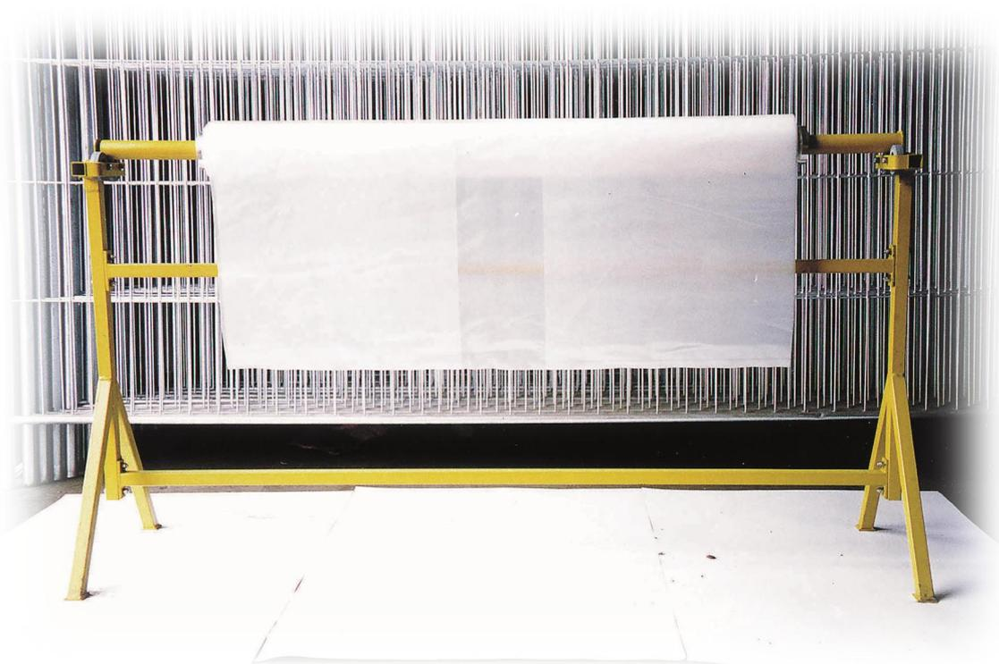
Ce matériel permet de dérouler un rouleau de film à plat, film dossé, ou gaine à palettes ou de housses prédécoupées. Il est constitué de 2 pieds, 2 entretoises horizontales et de 4 roulettes qui permettent de faire tourner l'axe porte bobine.
