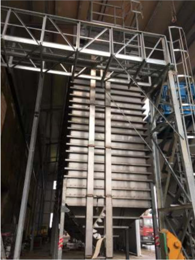
Batterie à cellules à parois plates, réalisée en acier inoxydable pour le stockage du riz blanc, lisse avec raidisseurs extérieurs apparents, sur une structure métallique.
