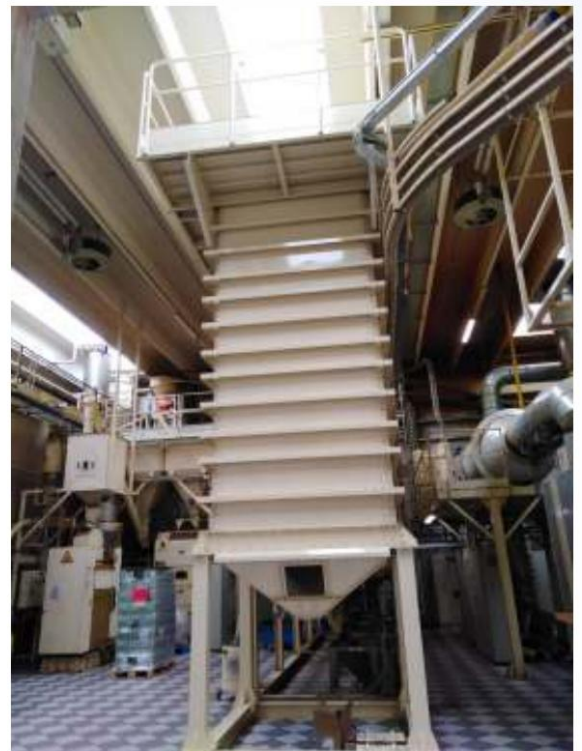
Cellule simple paroi plate, lisse avec raidisseurs extérieurs apparents, sur structure métallique, pour grains de café crus.
