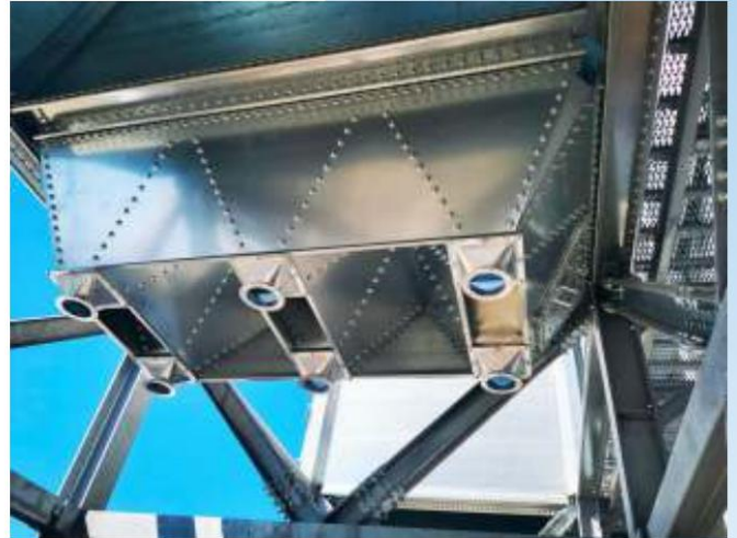
Batterie de cellules à parois plates avec trémie de déchargement multiple pour le stockage de produits mélangés/blé conditionné.
