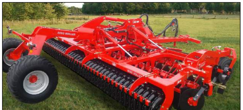
Disc-Roller Contour 6,5 m rouleau V-profil, tablier caoutchouc, roues frontales pivotantes et attelage sur bras de relevage
