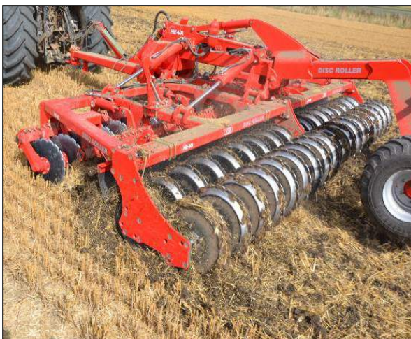
Disc-Roller Contour 5,5 m avec rouleau Twin V-Profil et tablier caoutchouc
