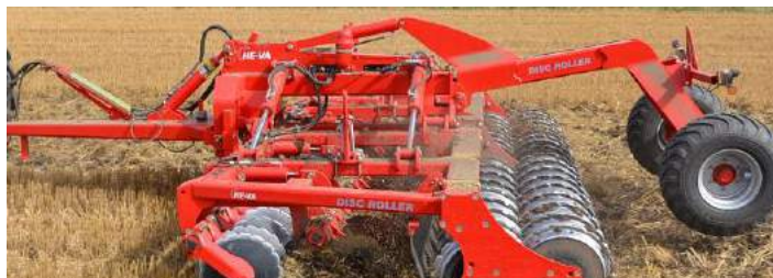
5,50 m Disc-Roller Contour avec rouleau double Twin V-Profil & tablier caoutchouc.
