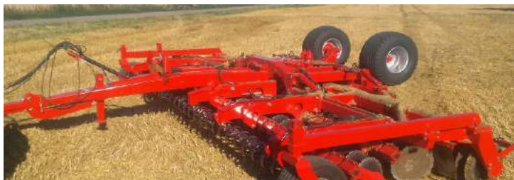
Disc-Roller Contour 8,0 m avec rouleau V-Profil & roues support tournantes.
