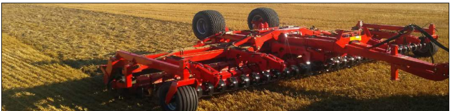
Disc-Roller Contour 8,0 m avec rouleau V-Profil, tablier caoutchouc, Spring-Board & roues frontales pivotantes
