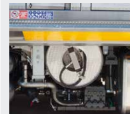
Installation d'eau haute pression
