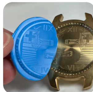
Exemple d'utilisation du P80 Ra pour du contrôle de rugosité
