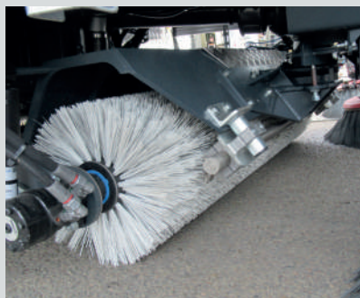
BALAI CENTRAL TIRÉ FLOTTANT AVEC RAMPE DE LAVAGE
