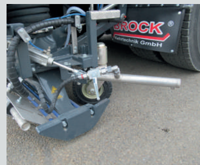
RAMPES HAUTE PRESSION LATÉRALES
