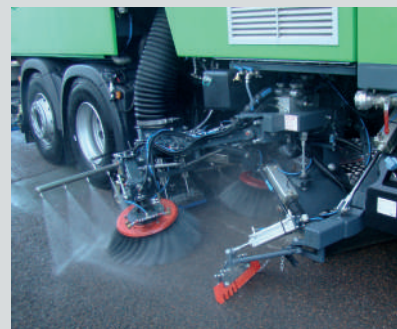
GRATTOIR ET RAMPE DE LAVAGE SUR GROUPE DE BALAYAGE
