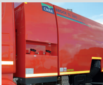
CUVE À EAU DERRIÈRE LA CABINE
