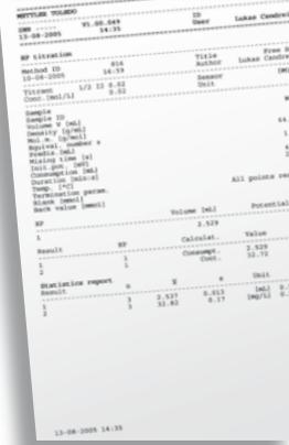
Le DL22 F&B calcule automatiquement les résultats dans les unités prédéfinies. Selon la méthode, METTLER TOLEDO a prédéfini les calculs les plus courants et les unités correspondantes. Les résultats sont enregistrés et peuvent être envoyés sous forme de compte rendu à l'imprimante compacte avec l'imprimante METTLER TOLEDO RS-P42.
