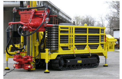
Caricatore aste Pipe loader Chargeur de tiges Bohrgestänge-lader Cargador de barras Автопогрузчик штанг
