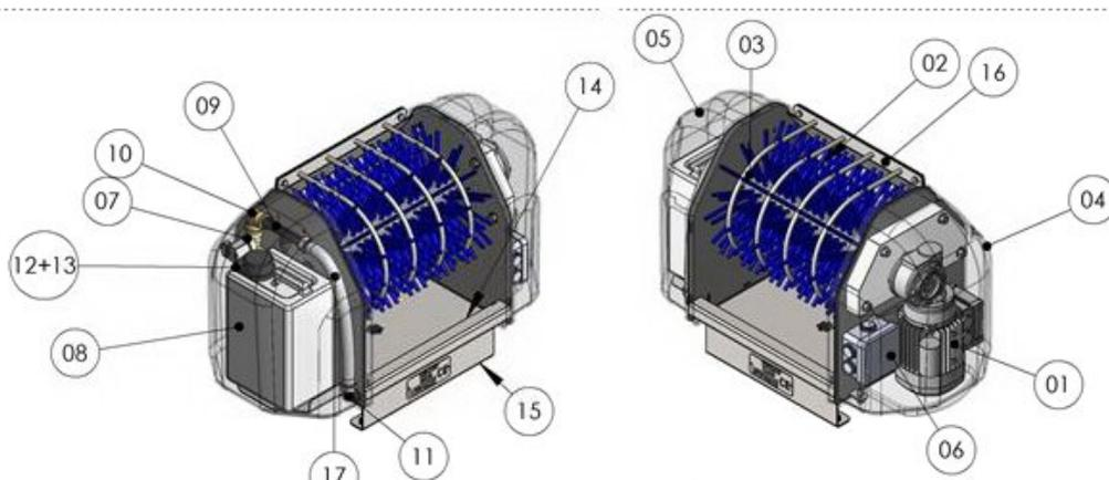
Le lave-semelles BOBY WASH permet de laver et désinfecter les semelles et le dessus de la chaussure ou de la botte. C'est un appareil d'appoint qui peut se positionner rapidement partout où cela est nécessaire sans avoir à passer pas le SAS d'hygiène. Par exemple : à l'extérieur des bâtiments, à proximité des bureaux, près de l'atelier de maintenance...
