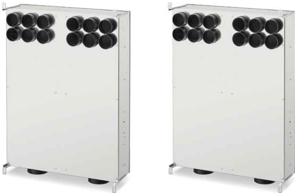
Kompakte Einheit für den Anschluss von Zu- und Abluft DN 125 und 2 mal 7 Einzelstutzen DN 75 mit der Zuluft auf der rechten bzw. linken Seite.
