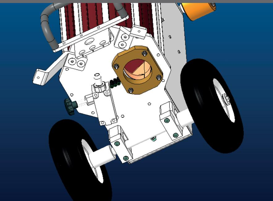
La machine dispose d'un entonnoir interne sous le plateau du système de vidange rapide (A) pour permettre à l'utilisateur de vider rapidement l'abrasif restant dans l'entonnoir.
