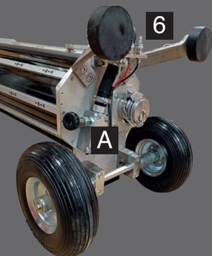
Grâce au système QuickConnect tuyaux RILSAN (6) il est possible de déconnecter les tuyaux rilsan du pistolet de manière rapide même pour les utilisateurs moins expérimentés, évitant d'éventuelles casses sur les raccords.
