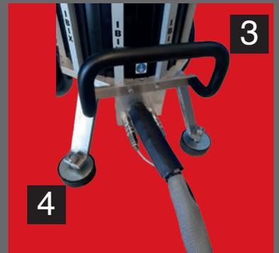
Grâce à la poignée (3) l'utilisateur sera soulagé lors du soulèvement de la machine. Enfin, les pieds auto-bloquants (4) avec le caoutchouc anti-vibrations permettront une adhérence parfaite sur le sol offrant une meilleure stabilité.
