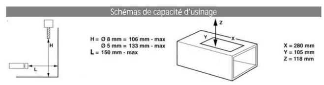
Dimension max. profilé usinable avec enlèvement maximum L=76mm
