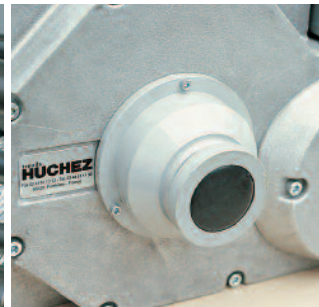
Tambour débrayable (500 à 960 kg). A n'utiliser qu'en halage.
