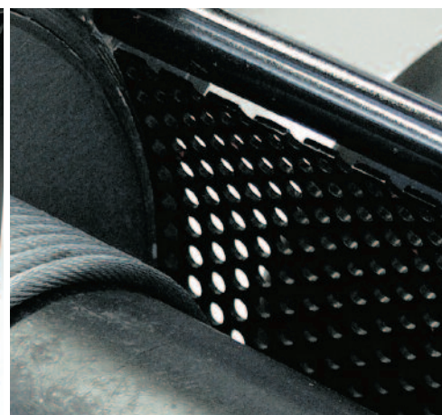
Tambour protégé par une tôle orientable perforée. Larges flasques pour une grande capacité de câble.
