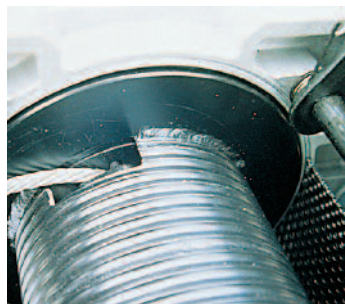
Tambour rainuré Indispensable pour installer un système de va-et-vient.
