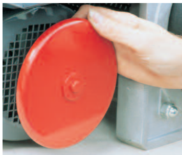
Manette de déblocage du frein et volant de dépannage Permet, sans courant, de descendre ou positionner une charge.
