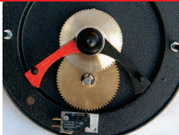
Fins de course haut et bas Facile à régler et très fiable.
