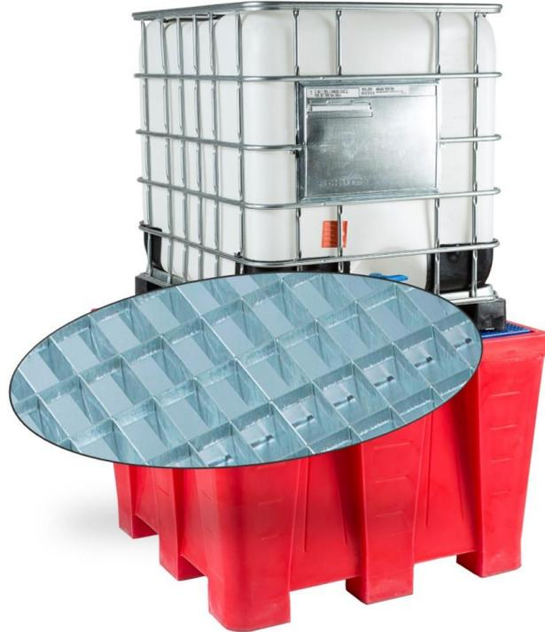
Les bacs de rétention en plastique sont particulièrement adaptés aux acides et bases. Conçu en polyéthylène avec un caillebotis acier galvanisé à chaud, ils regroupent de nombreux avantages : légèreté, facilité de nettoyage, longévité, résistance à la corrosion et aux produits chimiques. Le bac de rétention MRG1200 présente une capacité de rétention de 1200 litres.
