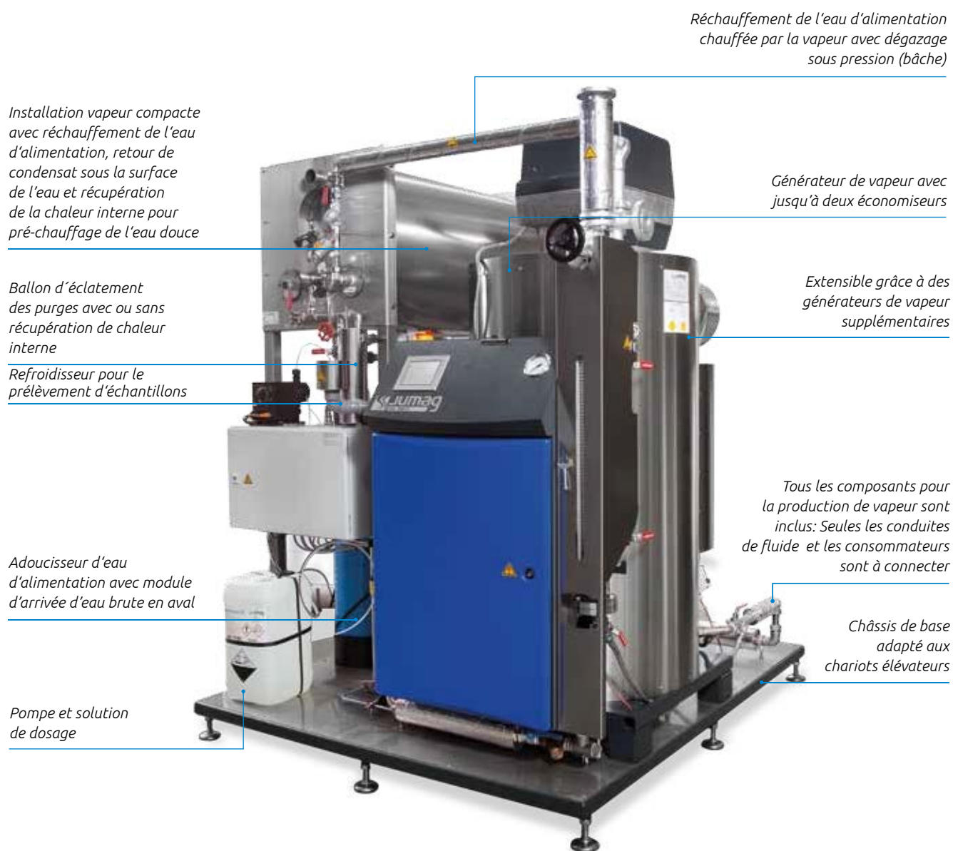
Fig. : Installation vapeur compacte, exemple de présentation
