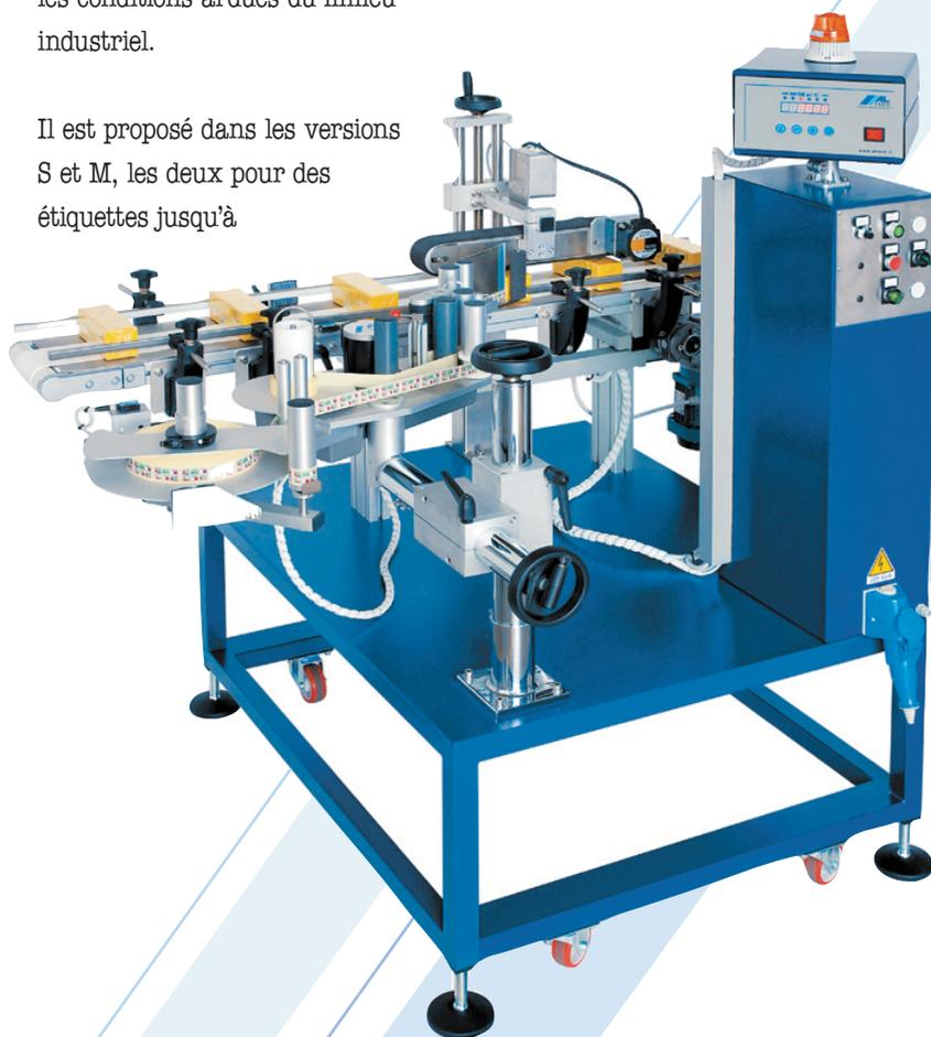
**Impianto dotato di unità ALstep per l'applicazione di etichette laterali su astucci.**
