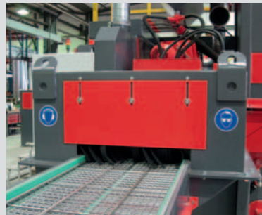
Zone d'entrée avec guidage latéral des pièces
