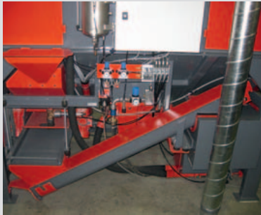
Épuration de la grenaille par tamis vibrant et séparateur en cascade
