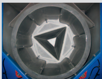
Tambour en acier haute résistance avec cône de forme optimisée
