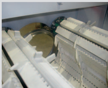
Tablier en lamelles de caoutchouc pour retourner délicatement les pièces
