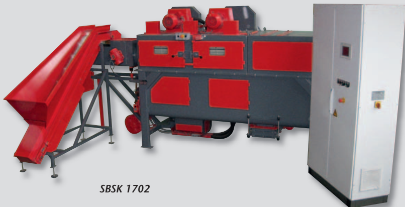
Tablier en lamelles de caoutchouc pour retourner délicatement les pièces
