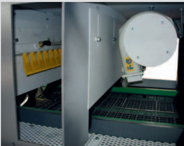
Nettoyage des pièces par air comprimé et soufflante
