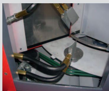
Chambre de soufflage et buses
