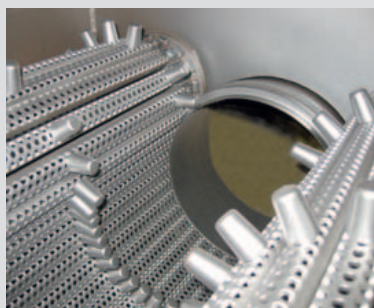
Tablier en lattes métalliques perforées pour l'ébavurage de petites pièces
