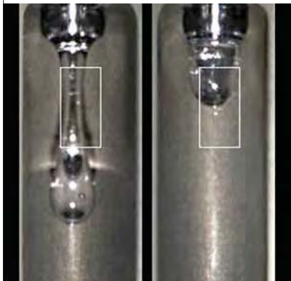
Image en temps réel de la vidéo de la détermination du point de goutte d'un copolymère EVA
