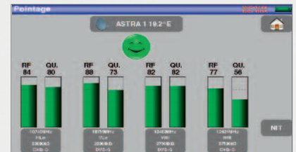
Pointeur satellite avec affichage de la NIT pour assurer un réglage optimal.
