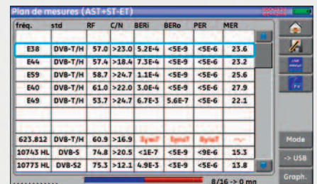
Enregistrement horodaté des mesures sur clé USB, avec création automatique d'un fichier csv. Durée d'enregistrement : plusieurs jours.
