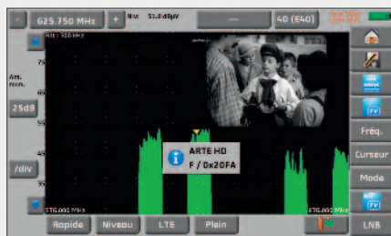
Affichage en incrustation du programme TV correspondant au canal pointé. Fonctionne en terrestre, câble et satellite. Affiche les informations de « Network name » et « Network Id ».
