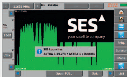
Affichage en incrustation du programme TV correspondant au canal pointé. Fonctionne en terrestre, câble et satellite. Affiche les informations de « Network name » et « Network Id ».
